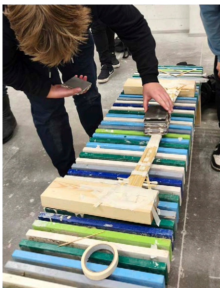
Ehituse töötoas ehitati grilltikkudest sild, mis peab kandma võimalikult palju keraamilisi plaate. Foto: Margot Keres
